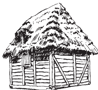
Drážková konstrukce roubené usedlosti. Spařence (Sobotecko)
